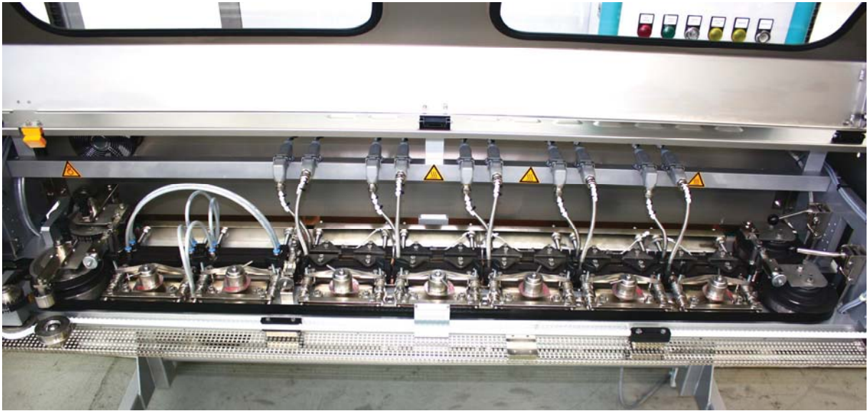
Station à bande d'une CBS-W 1000, machine à grande vitesse très court avec 5 paires de barres de chauffe et 2 paires de barres de refroidissement à l'eau
